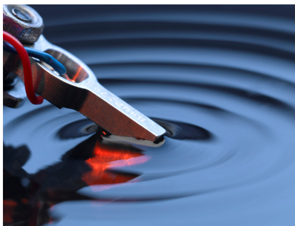
De Elliptec Motor kan ook fungeren als losse actuator. Hier wekt deze golven op in een vloeistof
